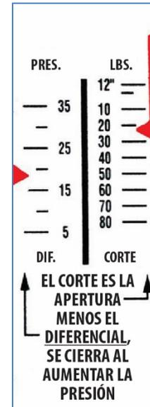
El lado izquierdo del control indica el diferencial de presión para desactivar (compresor apagado) y el lado derecho indica la presión para activar (compresor encendido).
