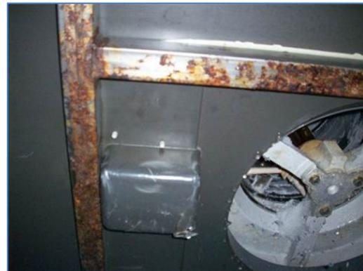
Si no se quita del agua, el cloro se mezcla con la humedad presente en la máquina para hacer hielo en escamas y el cubo para hielo, para formar un ácido clorhídrico diluido. Este ácido puede provocar que se forme óxido en las superficies del acero inoxidable, en uno o dos años.
